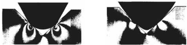
Kuvassa levyn uraan kohdistuva painevaikutus 2 gramman neulapainolla mitattuna.
